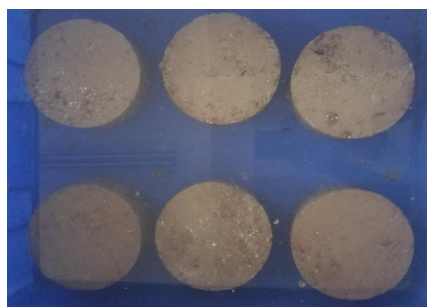
无侧限抗压强度试件浸水
