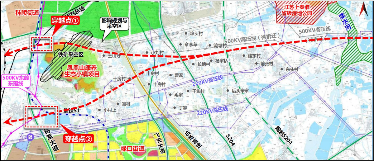
图 3- 66 500kv 东峰东廻线耐张段点位
