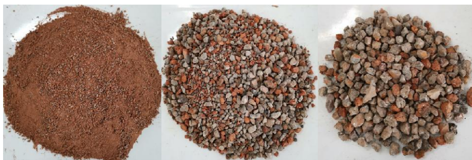
不同粒径范围的砖混再生骨料
